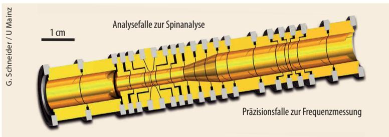
Abb. 2 Eine Doppelfalle besteht aus einer Analysefalle und einer Präzisionsfalle, die über Transportelektroden verbunden sind. Aus der Axialfrequenz des Teilchens in der Analysefalle mit inhomogenem Magnetfeld ergibt sich der Spin. Das homogene Magnetfeld in der Präzisionsfalle liefert die Zyklotronfrequenz. Als Kombination der Werte resultiert das magnetische Moment.
