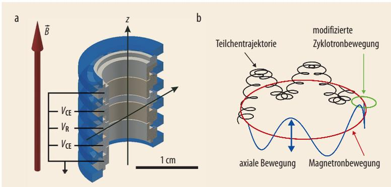
Abb. 1 In einer Penning-Falle zwingt ein homogenes Magnetfeld  $B$  in Richtung der Fallennachse einzelne Ionen auf eine stabile Trajektorie (a). Ein elektrostatisches Quadrupol-Potential – erzeugt von den Spannungen  $V_{CE}$  und  $V_R$  an den fünf zylindrischen Elektroden – fängt das Ion in axialer Richtung ein. Das Ion führt eine Überlagerung aus drei Bewegungen aus (b).
